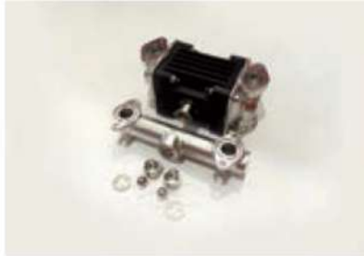
Шаг 2 Снимите напорный коллектор, седла, шарики и кольца клапанов. Выполните ту же процедуру (шаги 1 и 2) чтобы удалить также всасывающий коллектор
