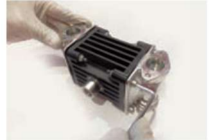
Шаг 3 Разберите корпус насоса, раскрутив винты
