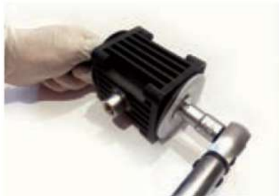
Шаг 5 Разберите диафрагмы раскрутив внешние крышки удерживающие диафрагмы и снимите диафрагмы и внешние поршни
