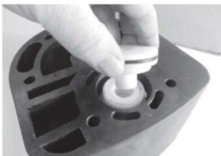
Шаг 3б Снять обе крышки и вал воздушного клапана с противоположной стороны
