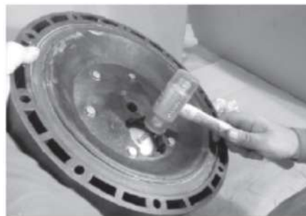
Шаг 2 Нажать на вал воздушного клапана с одной стороны
