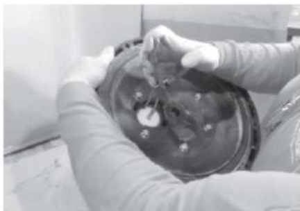
Шаг 1 Снять предохранители
