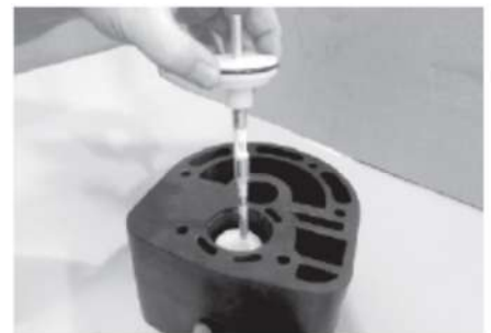
Шаг 3а Снять обе крышки и вал воздушного клапана с одной стороны
