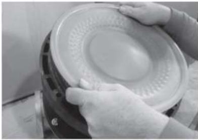
Шаг 4 Разъедините руками диафрагму от центрального блока и отцепите её левым вращением
