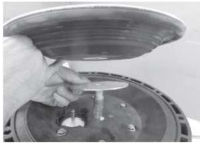
Шаг 5 Раскройте корпус и вытащите диафрагму вместе с валом. Разъедините диафрагму с вала
